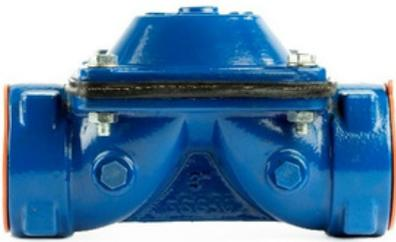
La vanne hydraulique en fonte FLUM VALVES est une vanne hydraulique à membrane de type SANDERS à chambre unique, avec une opération basique d'ouverture et de fermeture due à la pression exercée par l'eau dans la canalisation.
