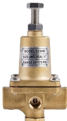
El piloto modelo 123HR tiene la función de reducción de presión de 2 vías actuando por diafragma, el cual se encuentra en posición de abierto dada la presión del muelle que actúa sobre el diafragma. Cuando la presión aguas debajo de la válvula supera el punto regulado, se cierra el paso de agua, consiguiendo de este modo la regulación de presión.
